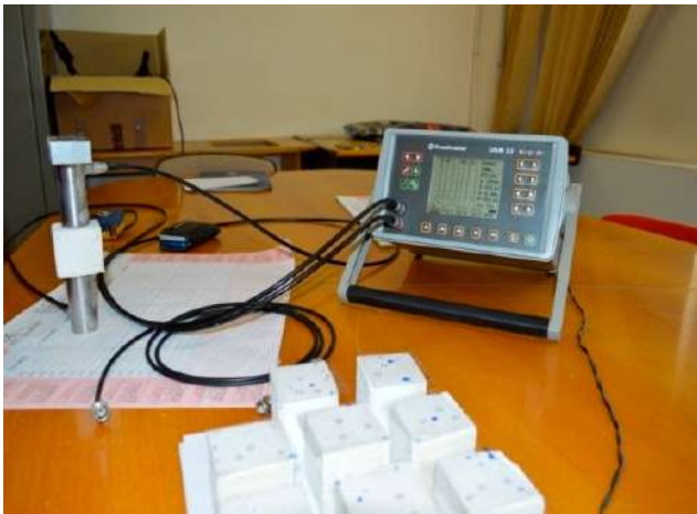
Fig. 5.4 - Misura US con sonda da 50 kHz
