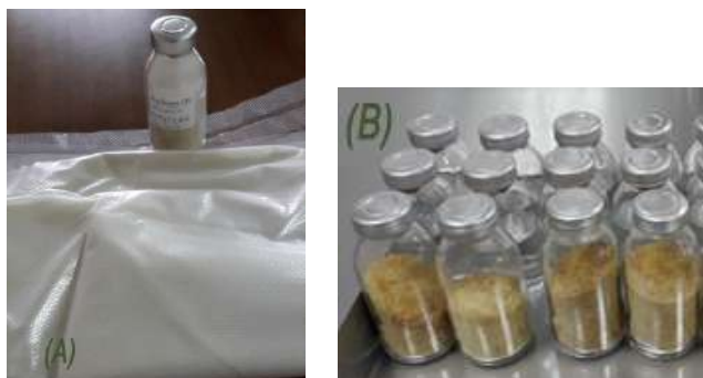
Fig. 4.7 - Liofilizzati: (A) appena confezionati in busta e flacone; (B) dopo conservazione in flaconi sottovuoto per 30 giorni
