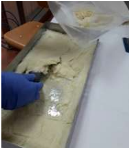
Fig. 4.6 - Omogeneizzazione del prodotto mediante trasferimento in busta dei liofilizzati dei 7 vassoi
