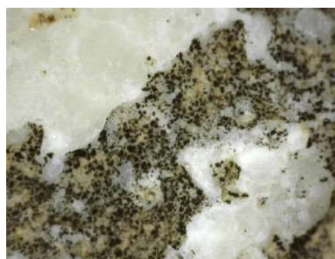
Fig. 7.3 - In alto: macrofotografia della superficie erosa con patina biologica; in basso: patina biologica al microscopio digitale (50x)
