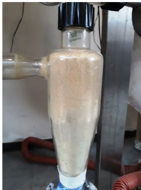
Fig. 4.10 - Raccoglitore spray dryer in funzione
