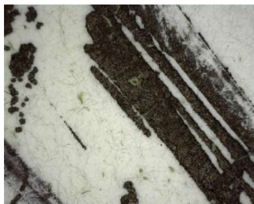
Figura 6.10 - Campioni di carta non trattati, 8 settimane dopo l'inoculo con spore fungine (ingrandimento 50x). in alto: carta Kozo-shi; in basso: carta Fabriano
