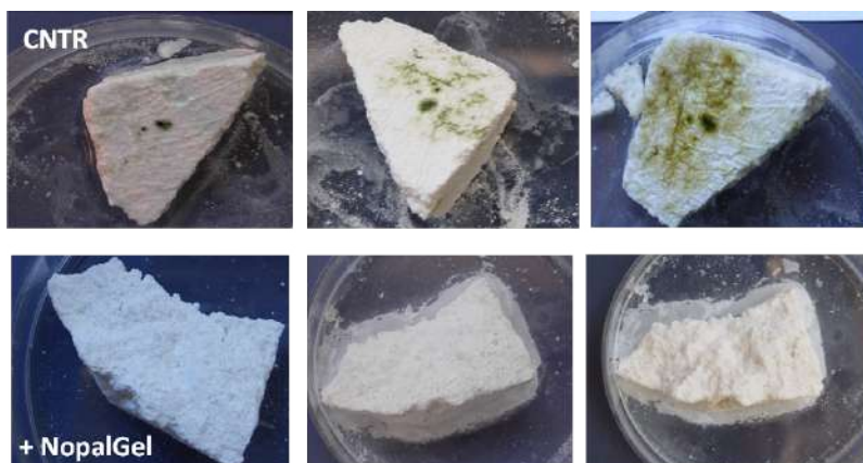
Fig. 6.3 - Provini di malta inoculate con biofilm fotosintetico: in alto la progressione dell'attacco nella malta di controllo dopo 15, 30 e 62 giorni. Nelle foto in basso, la malta addizionata di NopalGel non viene colonizzata dal biofilm
