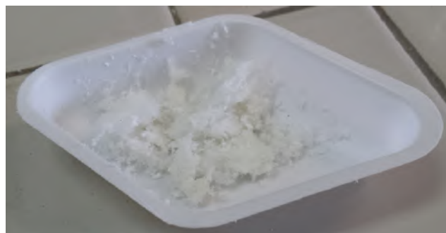
Fig. 4.2 - Prodotto liofilizzato dopo la rimozione della clorofilla come descritto nel capitolo 3
